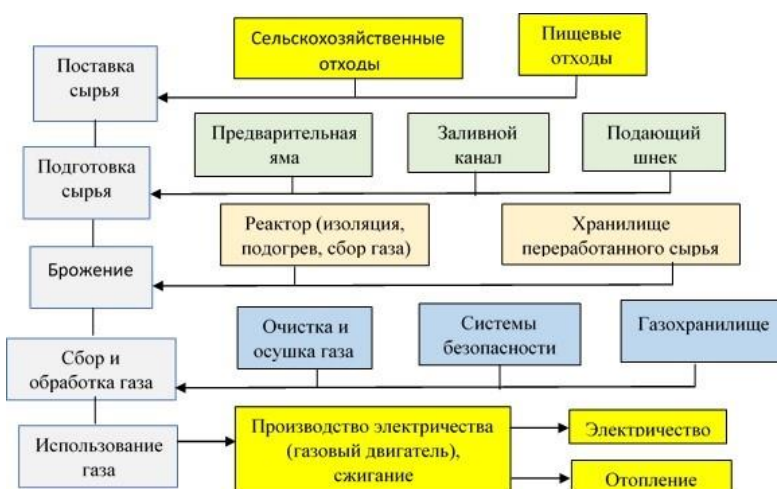
Рисунок 1. Схема получения энергии из отходов
