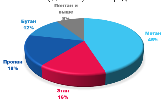
Рисунок 2. – Компонентный состав попутного нефтяного газа
