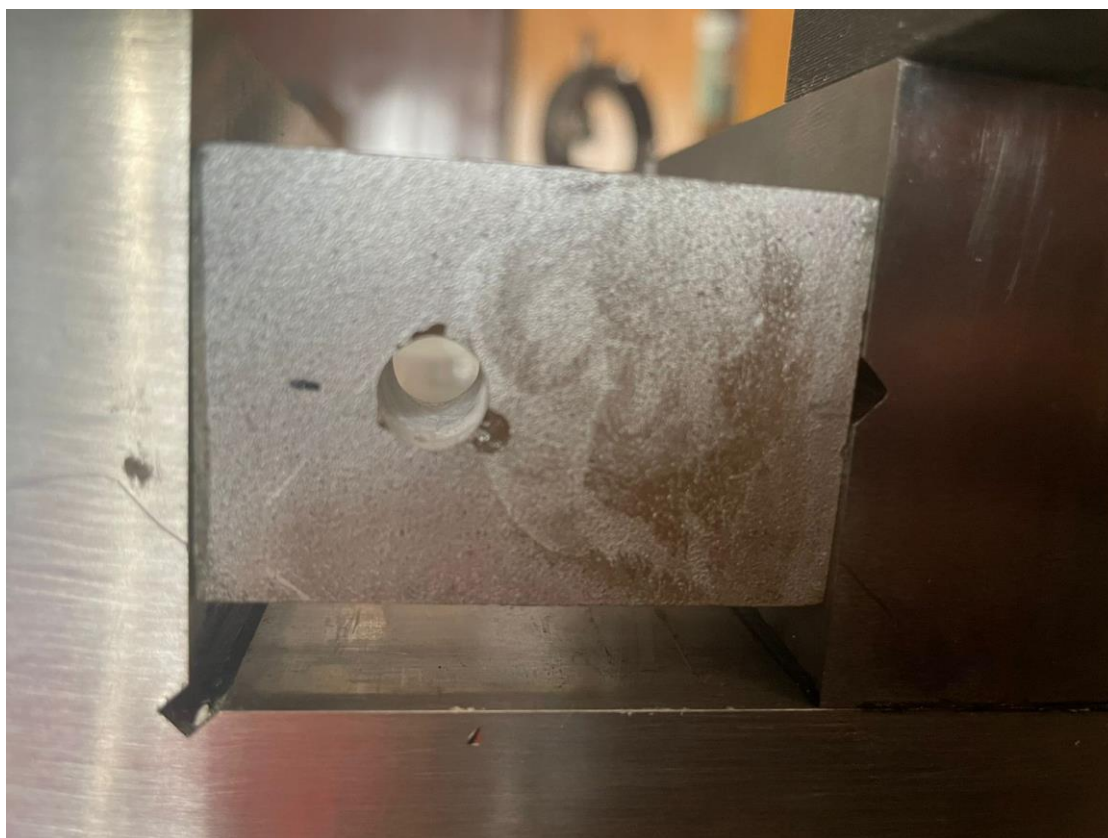
Рисунок 2.11 – Образец, параллелепипедом со сквозным отверстием.
