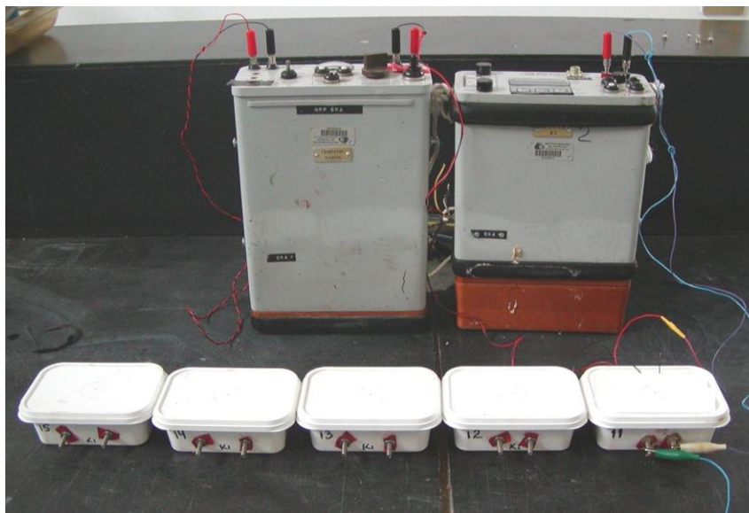
Рис.1. Измерение сопротивления в 5 резистивиметрах
