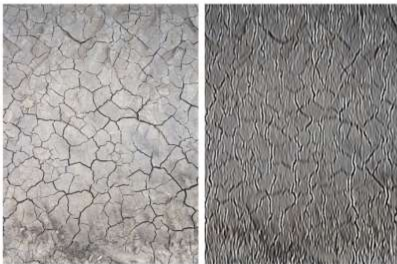
Рис. 10. Применение фильтра Габора: слева – исходное изображение, справа – обработанное
