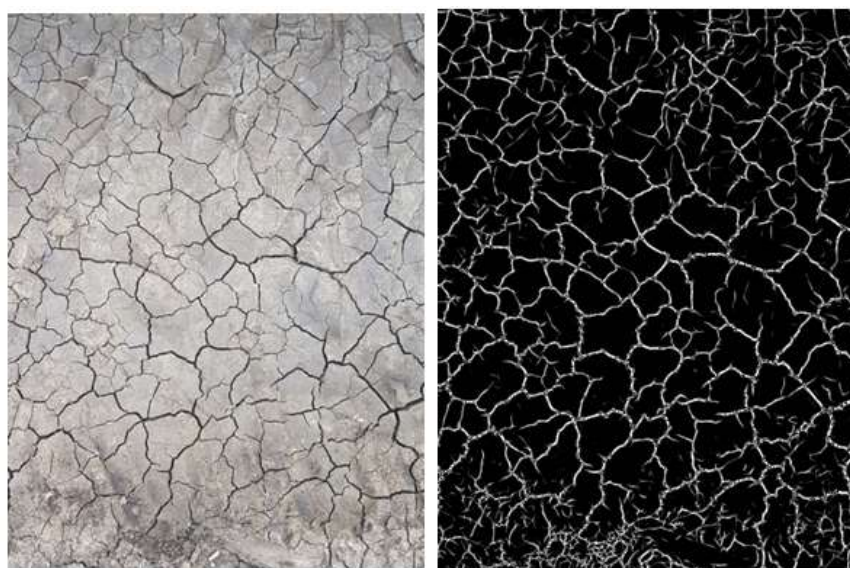
Рис. 3. Применение серии фильтров с последующей бинаризацией и сложением: слева – исходное изображение, справа – обработанное
