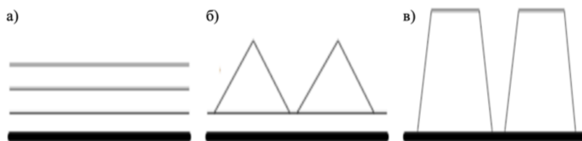
Рисунок 38. Схематическая иллюстрация термодинамически обусловленных механизмов эпитаксиального роста пленки: (а) механизм послойного роста (механизм Франка-ван дер Мерве), (б) механизм смешанного роста (механизм Странского-Крастанова), (в) механизм островкового роста (механизм Фольмера-Вебера).
