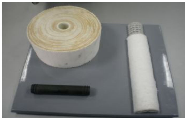
Рис. 1. Мембранный фильтр, применяемый для очистки питьевой воды (г. Алчевск, з-д "Аква", фото Косоговой Т.М., 2012)
