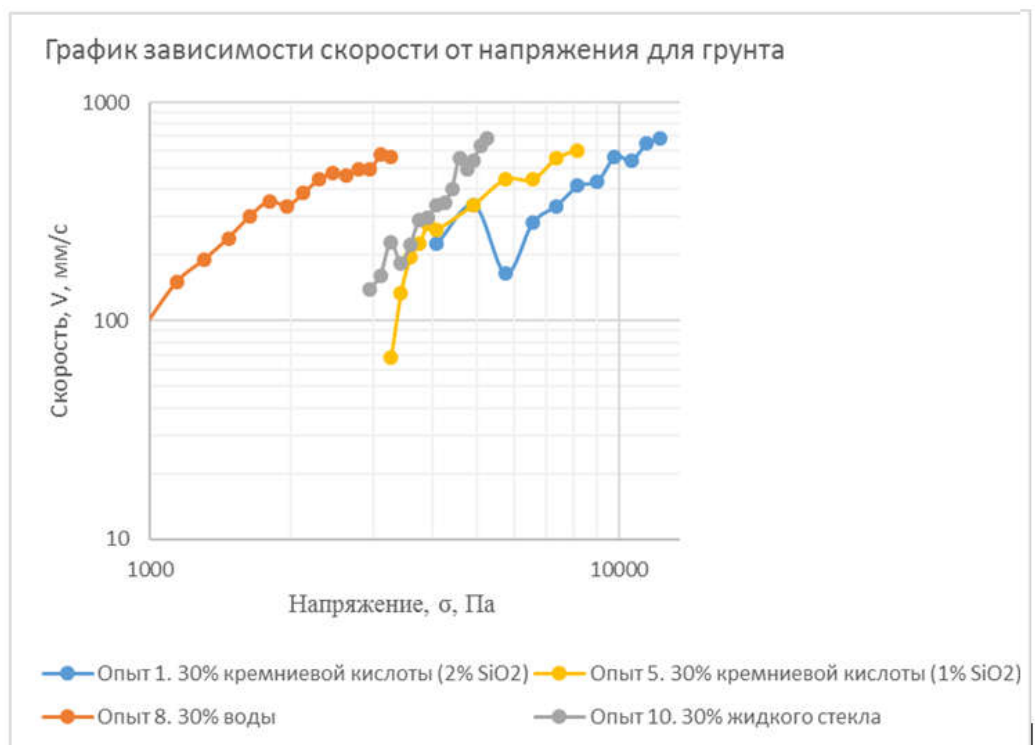
Рис. 2 - Зависимость скорости V движения грунта от создаваемого напряжения \sigma при 30% насыщении растворами
