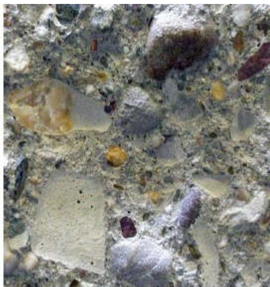
Рис. 4 – Внутренняя структура бетонного камня
