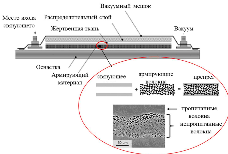
Рисунок 1.2 – Процесс вакуумной инфузии
