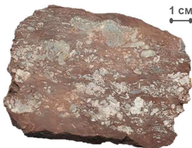
Рисунок 7.10 Гравийно-песчано-глинистая порода трансгрессивной части нижнего циклита (скв. Придутская-3 гл. 2596.5 м)
