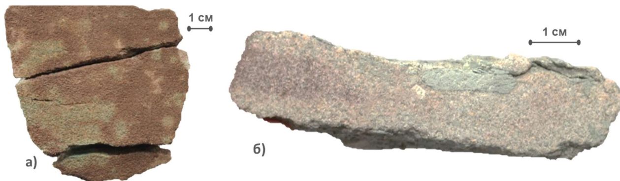
Рисунок 7.14 Песчано-гравийные породы косослоистые (а), с включениями интракластов серо-зеленых глин (гл. 2765.6 м) и дресвяно-гравийные отложения (б) пестроцветные, пятнистые (гл.2765.0 м) в скважине Придутская-2
