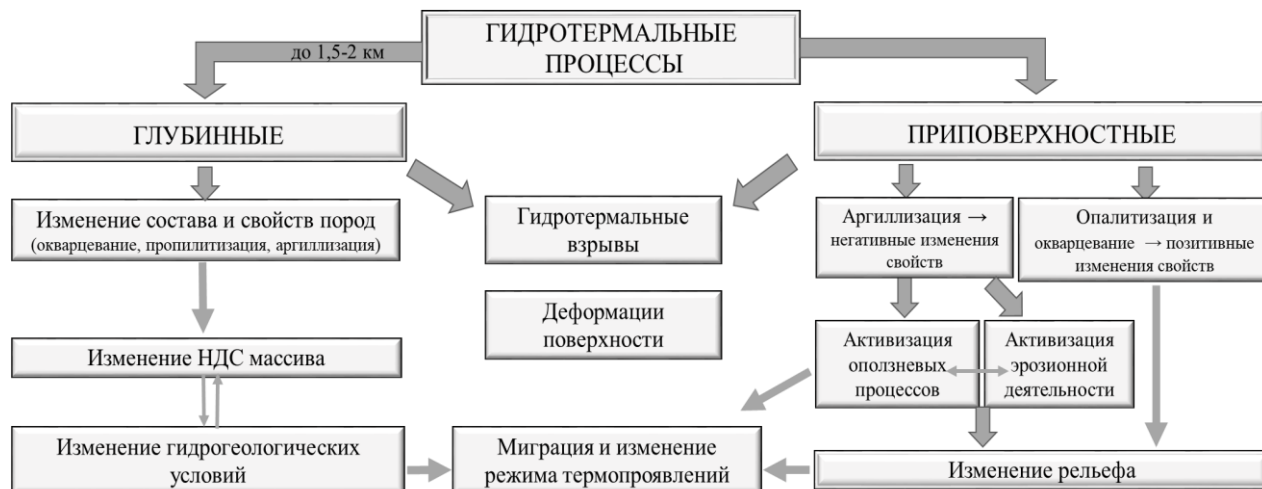
Рисунок 14 – Некоторые геологические последствия и явления, вызванные гидротермальной деятельностью, и их взаимосвязь
