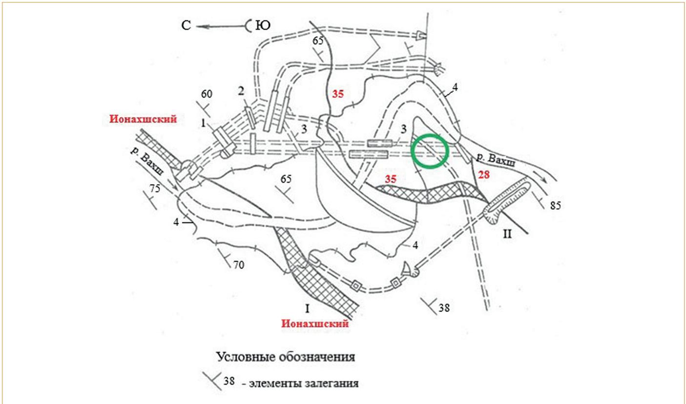
Рис. 2. Схема размещения сооружений Рогунской ГЭС [1] с изменениями. Обозначения: 1 — водоприемник, 2 — шахта; 3 — отводящие туннели; 4 — контур плотины. Тектонические разломы с зонами дробления подписаны красным цветом: I — Ионахшский второго порядка, II — малые № 28, 35 — третьего порядка). Зеленой окружностью показан исследуемый участок трассы туннеля
