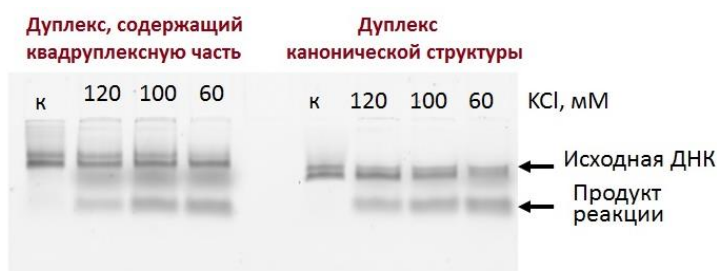
Рис. 1. Анализ расщепления дуплексов, содержащих флуорофор TAMRA на 3'-конце «нижней» цепи, эндонуклеазой MutH в 10%-ном геле, содержащем 7 М мочевины и 10% формамид. к – дорожки с исходным фрагментом ДНК. Реакцию проводили в 20 мМ буфере HEPES/КОH (рН 8,0), 5 мМ MgCl 2 , содержащем 60, 100 или 120 мМ KCl при 37°C в течение 1 ч.
