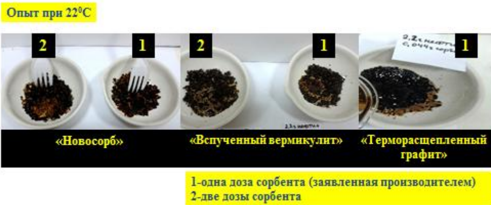
Фото 23. Оценка эффективности минеральных сорбентов и терморасщепленного графита при 22 °С с использованием 1-й и 2-х доз сорбента
