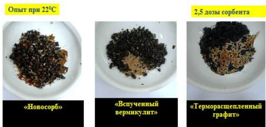
Фото 24. Оценка эффективности минеральных сорбентов и терморасщепленного графита при 22 °С с использованием 2,5 дозы сорбента
