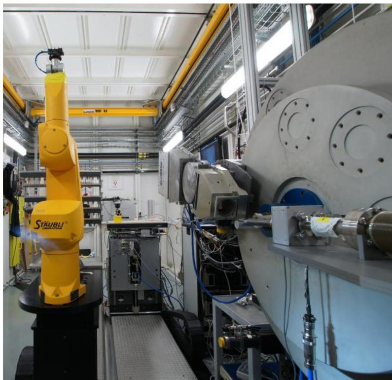
Рис. 6.3. Измерительная установка ID22, вид со стороны падающего пучка рентгеновского синхротронного излучения. Слева – роботизированная установка для смены образцов (желтого цвета).
