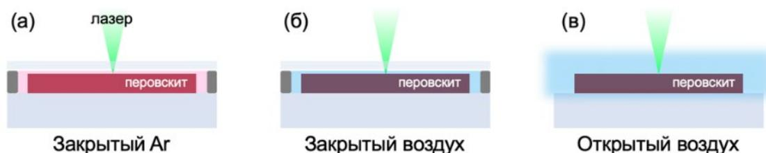
Рисунок 54. Схематичное изображение образцов перовскита в условиях закрытой инертной атмосферы (а), закрытой окислительной атмосферы (б) и открытой окислительной атмосферы (в) в ходе съемки спектров КР.
