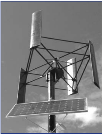
Рис. 5. Ветро-солнечная ВЭУ-0,1 (фото ООО "ГРЦ-Вертикаль")
