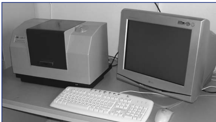
Рис. 8. Общий вид мобильной ЭС оценки качества углеводородных соединений, построенной с использованием в качестве источника спектральных данных ИК-Фурье-спектрометра "АФ-1"
