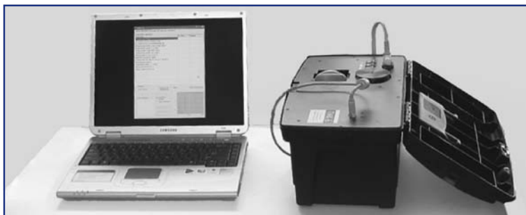
Рис. 9. Общий вид переносной ЭС оценки качества углеводородных соединений, построенной с использованием в качестве источника спектральных данных ИК-Фурье-спектрометра "ПФС-1"
