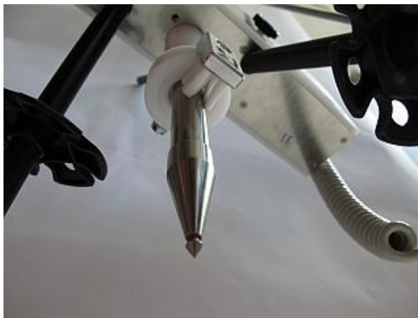
Рисунок 20.1. Щуп с датчиком сопротивления SMP.
