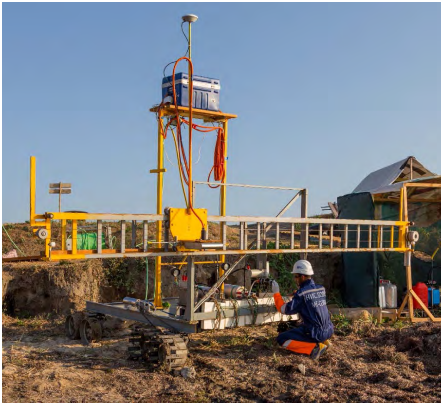
Рис. 2. Внешний вид платформы «Слейпнир» с профилографом SES-2000.
