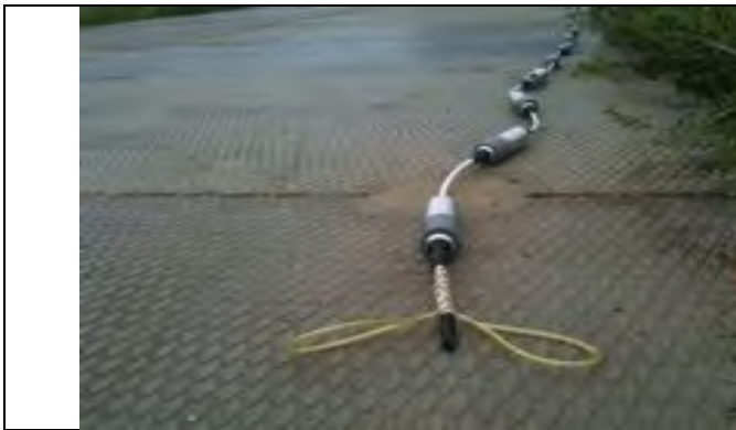
Рис. 1. Измеритель вертикального акустического и температурного разрезов.
