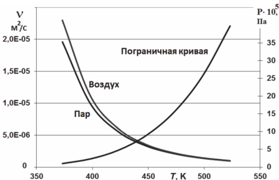
Рис. 3. Кинематическая вязкость пара и воздуха для давления и температуры вдоль кривой насыщения
