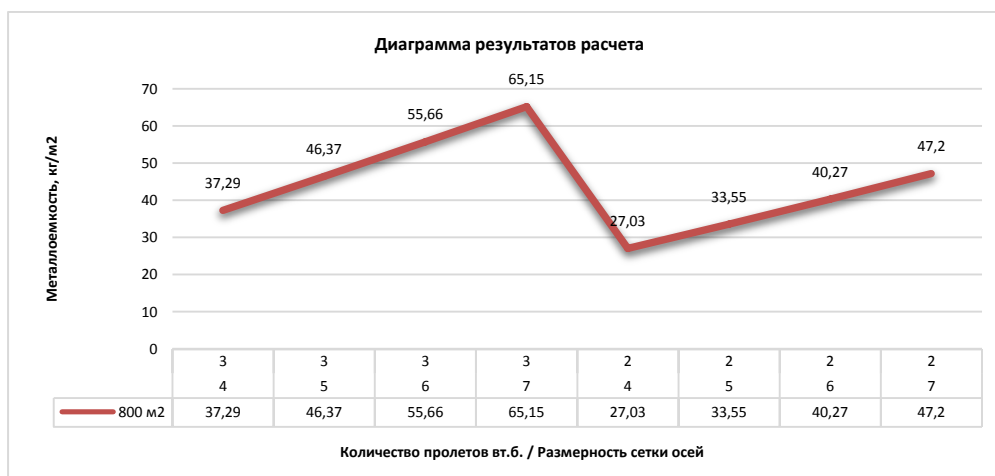
Рис. 11. Диаграмма зависимости металлоемкости от размерности сетки осей и количества пролетов второстепенной балки
