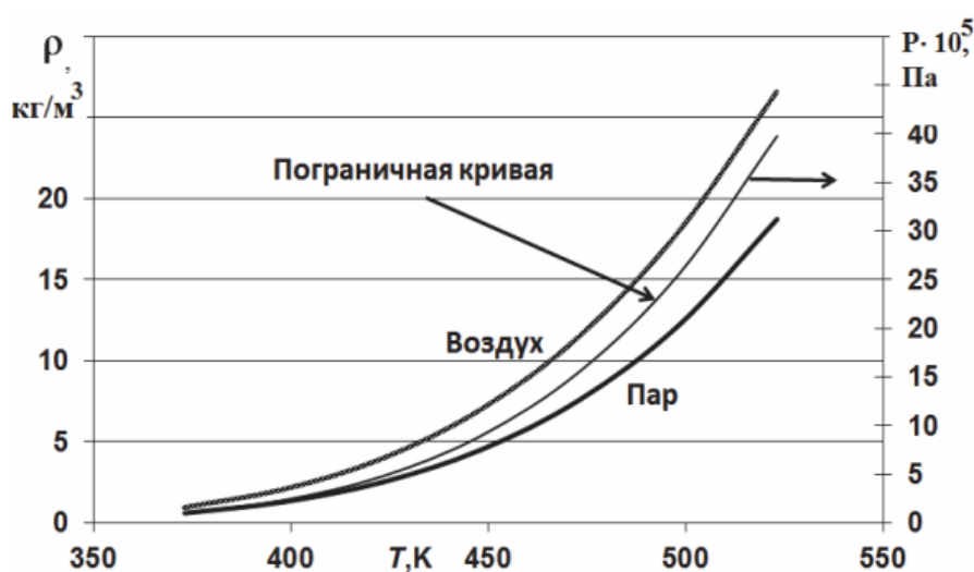
Рис. 2. Плотность водяного пара и воздуха для давления и температуры вдоль кривой насыщения
