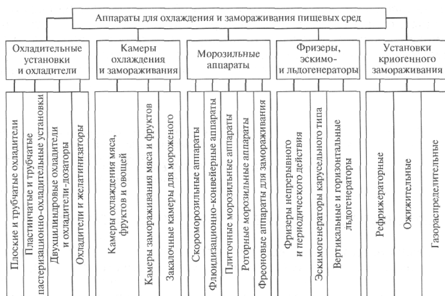
Рис. 1. Классификация аппаратов для охлаждения и замораживания пищевых сред
