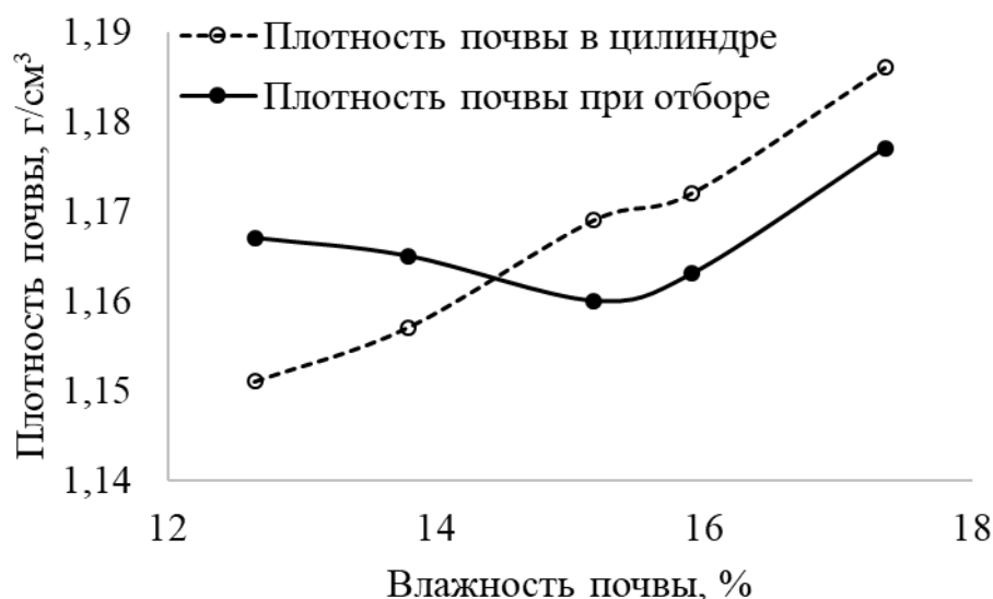
Рисунок 3 – Плотность сложения почвы при разной влажности в цилиндре и при отборе буром-пробоотборником
