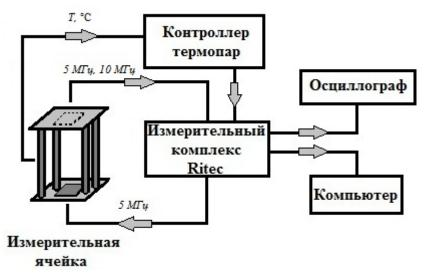
Рис.1. Блок схема установки
