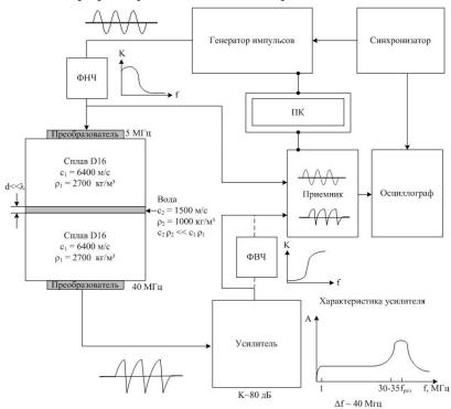
Рис.1 Схема установки и основные характеристики
