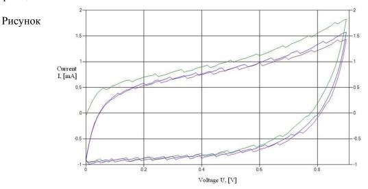
Циклограмма ВАХ образца СК-ячейки.
