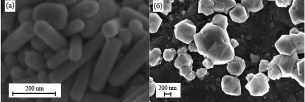
Рис 1. РЭМ изображения сконденсированных из газовой фазы (а) наноуглеродных стержней (стальная подложка) и (б) микрокристаллитов алмаза (кремниевая подложка)
