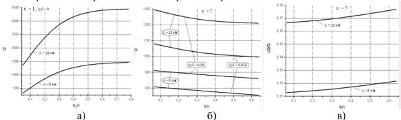
Рис. 2. Зависимость добротности от длины запредельной части (a) и параметров материала (б,в)
