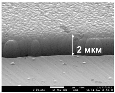
Рис. 1. РЭМ изображение ступеньки на границе с маской из хрома, сформированной по методу взрывной литографии после травления алмазной поверхности в плазме на основе  $SF_6/O_2$  20:1 в течение 60 минут.
