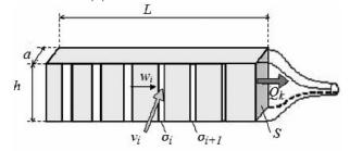
Рис.1 - Схема вытяжного газохода: a, h, L — ширина, толщина и длина;  $v_i$  — скорость газа в щели;  $w_i$  — продольная скорость газа; S — площадь поперечного сечения газохода;  $\sigma_i, \sigma_{i+1}$  - площадь предыдущей и последующей щели;  $Q_k$  - расход газа на выходе из газохода
