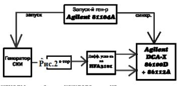
• генератор 250 пс импульсов амплитудой 500 мВ,
