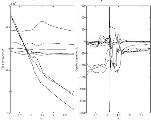
Рис. 3. Зависимость сценарных токов (сплошные линии) и выходных токов (пунктирные линии) от времени. Рис. 4. Зависимость ошибки слежения от времени.
