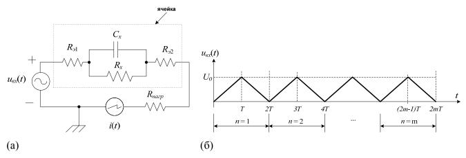
Рисунок 1. Эквивалентная схема измерительной схемы для исследования BAX электрохимической ячейки типа суперконденсатора (а) и временная зависимость приложенного напряжения при измерениях циклограммы (б).
