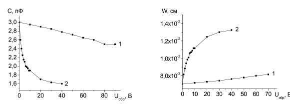
1-двухсторонне-диффузионная  $p^+p^-n^+$ -структура; 2-эпитаксиально-диффузионная  $p^+p^-n^+$ -структура.
