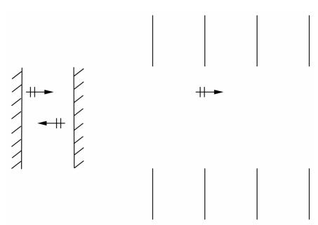
Рис 1. Резонатор Фабри – Перо и соответствующая ему система поглощающих экранов.
