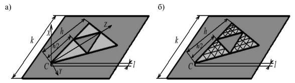
Рис. 1 — (a) Треугольная двухдиапазонная плоская антенна, (б) двухдиапазонная плоская антенна разбитая на элементарные площадки постоянного поверхностного тока
