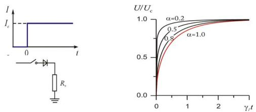
Рис. 1. Кинетика напряжения при переключении диода из нейтрального в пропускное состояние ступенькой тока в условиях дисперсионного транспорта.
