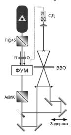
Рис.1. Схема экспериментальной установки.  $\Pi$  - поляризатор, A - анализатор, O - образец, H - магнитное поле,  $\Phi$ УМ - фотоупругий модулятор, CД - синхронный детектор.
