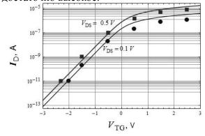
Рис.3 Сравнение расчетных (линии) и экспериментальных (точки) входных ВАХ [3] для верхнего затвора при различных значениях напряжения сток-исток логарифмическом масштабе
