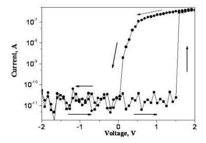
Рис. 2. Вольт-амперная характеристика структуры  $Nb_{\kappa o + a \kappa m}/Z n O_{c m e p ж n u}/г p a \phi e n$ . Литература
