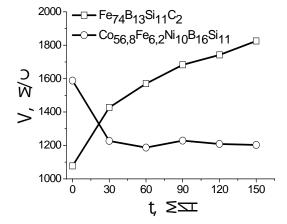
Рис. 1 Зависимость скорости распространения доменной границы от магнитного поля для микропровода с металлической жилой состава  $Fe_{74}B_{13}Si_{11}C_2$ , отоженного при температуре 300°C в течении 0-150 минут.
