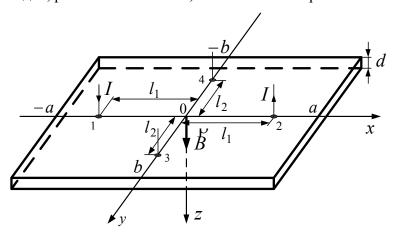
Рис. 1. Расположение контактов на поверхности полупроводниковой пластины
