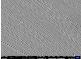
Рис.1. снимки поверхности кремниевой пластины с увеличением 5000х (WD=1,8 мм; EHT=5 кВ)
