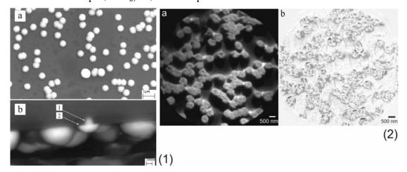
Рис. 1. (1) РЭМ изображения поверхности (а) массива столбиков никеля в матрице SiO2, и скола (b) исследуемого образца, содержащего столбики никеля (1 - "ножка" столбика, 2 – "шляпка" столбика). (2) РЕЕМ изображение морфологии (а) сформированных столбиков никеля в матрице SiO2 совместно с распределением остаточной намагниченности (b).
