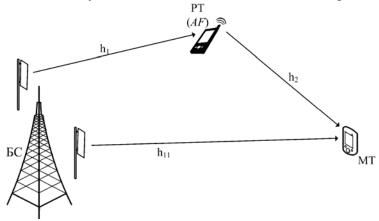
Рисунок 2. Схема кооперации с режимом аналоговой ретрансляции. Проведен анализ данной системы с помощью следующих формул [3].
