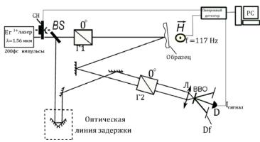
Рис.1. СН - механический прерыватель излучения, BS- светоделительная пластина,  $\overline{\mathbb{H}}$ -внешнее переменное магнитное поле,  $\Gamma$ 1 и  $\Gamma$ 2 призмы  $\Gamma$ лана,  $\Pi$  - линза, BBO - нелинейный оптический кристалл, D - детектор излучения, Df - апертура, PC - компьютер.
