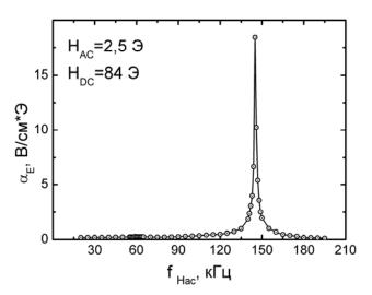
Рисунок 2 - Частотная характеристика магнитоэлектрического отклика
