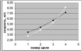
Рис. 3 – Распределение скоростей в щелях газохода: 1 – теоретический расчет по упрощенной методике, 2 – моделирование в Cosmos FloWorks
