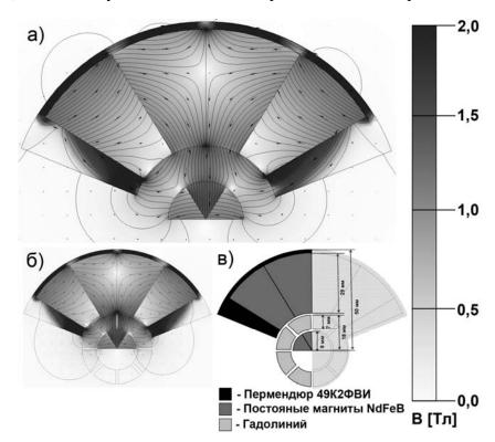
Рисунок 1. Конфигурация создаваемого системой магнитного поля: а) без рабочего тела; б) с рабочим телом; в) конструкция и линейные размеры магнитной системы.
