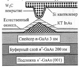
Схема измерения токового изображения поверхностных КТ *InAs GaAs*
