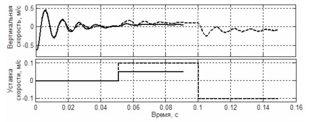
Рис. 2 Уставки и отработанные скорости при тестировании замкнутой системы
