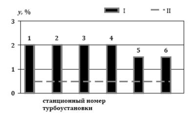
Рис.1. Влажность (y) за сепарационными блоками СПП-500-1 на турбоустановках (1–6) СмАЭС: I — значения до модернизации по данным работы [2]; II — проектное значение
