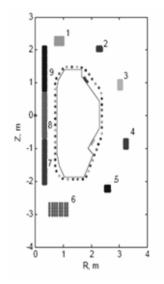
Рис. 1. Расположение катушек полоидального поля T-15.
