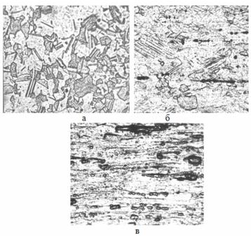
Изображение микроструктуры стали 12X18H10T (x1000); а- головка образца; б- рабочая часть 2; в- шейка.
