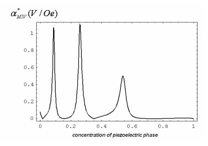
Рис. 1. Концентрационная зависимость МЭ коэффициента от концентрации пьезофазы в первичной секции МЭ трансформатора на частоте приложенного магнитного поля, равной 400 кГц. Параметры Terfenol-D берутся из работы [4], параметры PMN-PT из [4, 10].
