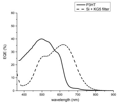
Рис.1 Спектры внешней квантовой эффективности (EQE) органического фотоэлемента РЗНТ-РСВМ и кремниевого фотодиода с фильтром KG5
