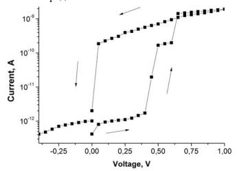
Рис. 1. Вольт-амперная характеристика структуры  $Al_{\kappa o \mu m}$ . Оксид графена/  $Al_{\kappa o \mu m}$ .
