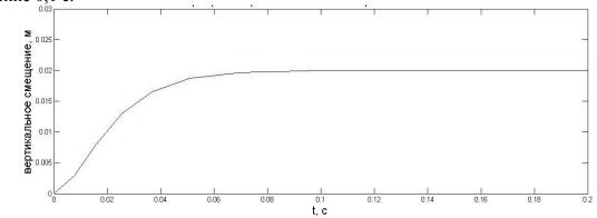
Рис. 2. Переходный процесс в системе управления Z(t).
