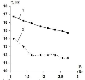
Рис.1. Задержка начала генерации T(1,2) и зависимость периода следования импульсов излучения  $\Delta T(3,4)$  от мощности накачки (1, 4- экспериментальные данные; 2, 3- расчетные данные)
