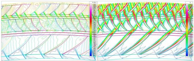
Рис.1. Поля статического давления и энтропии в НРС.
