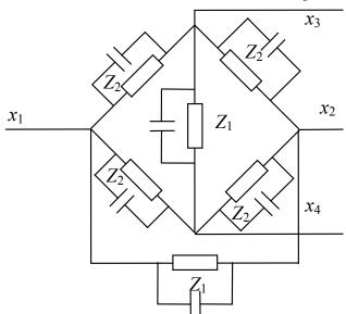
Рис. 1. Эквивалентная схема исследуемой среды
