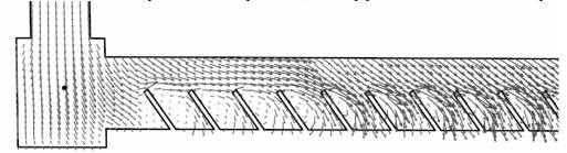
Рис.1. Векторы скорости в продольном сечении газодинамического клапана
