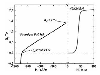
Рисунок 2. Полевые зависимости индукции для материалов используемых при моделировании.
