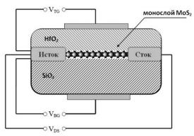
Рис.1 Конфигурация полевого транзистора с MoS<sub>2</sub> каналом и двумя затворами.
