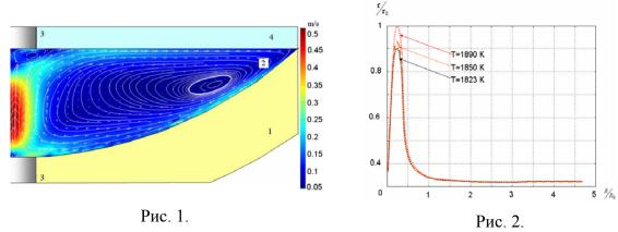
Анализируя полученные результаты показана возможность снижения величины сдвигового напряжения, а следовательно и износа футеровки, в непосредственной близости подового электрода на 15 % путем снижения температуры подового электрода.
