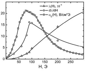
Рисунок 1 - Полевые зависимости магнитострикции, магнитострикционной "восприимчивости" и магнитоэлектрического коэффициента преобразования.
