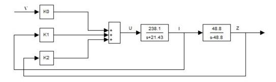
Рис.1. Структурная схема замкнутой системы управления.
