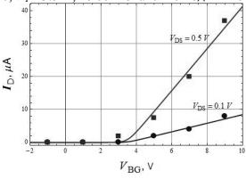
Рис.2 Сравнение экспериментальных (точки) и расчетных (линии) зависимостей [3] ток от напряжения  $V_{BG}$  при различных значениях  $V_{DS}$  (точки – эксперимент, линии – расчет)
