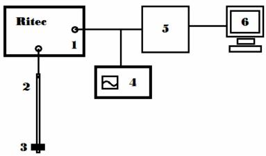
Рис.1.Блок-схема экспериментальной установки (1-ультразвуковой приёмно-передающий комплекс Ritec RPR-4000; 2-алюминиевая трубка; 3-нагрузка в виде резинового кольца; 4-осциллограф Agilent Infinium; 5-АЦП; 6-персональный компьютер).
