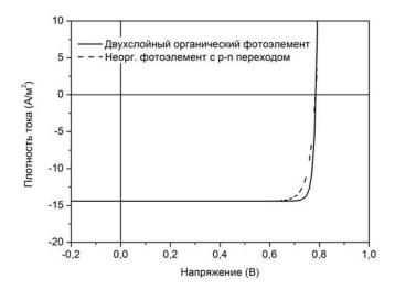
Рис. 1. Рассчитанные ВАХ для двухслойного органического фотоэлемента (сплошная линия) и для идеального неорганического фотоэлемента с током КЗ и напряжением XX такими же как у органического фотоэлемента (штриховая линия).
