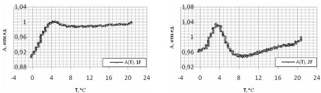
Рис.2. Зависимость амплитуд первой и второй гармоник акустической волны от температуры
