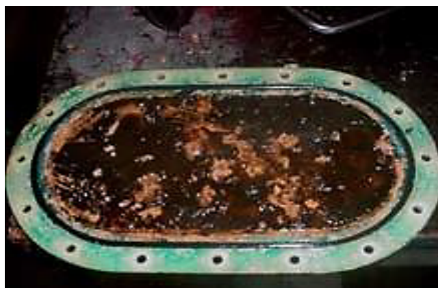
Рисунок 3. Панель топливного бака с микробиологическим загрязнением в виде биопленки [Матвеева и др., 2011].
