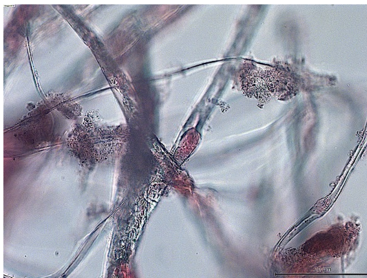
Рисунок 41. Фрагмент полимера СПАН с иммобилизованными Ochrobactrum sp. B11 на 14 сутки культивирования. На волокнах видны биопленка бактерий в виде грибовидных тел. Внеклеточный полимерный матрикс биопленки окрашен в розовый цвет, окрашивание рутениевым красным.
