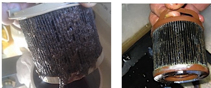
Рисунок 2. Примеры бактериального повреждения топливных фильтров [Матвеева и др., 2011].
