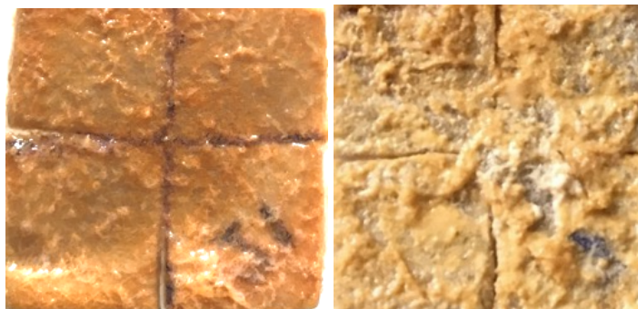
Рисунок 38. Внешний вид полимерной матрицы, использованной для иммобилизации клеток углеводородокисляющих бактерий, на 7 (слева) и 14 (справа) сутки.
