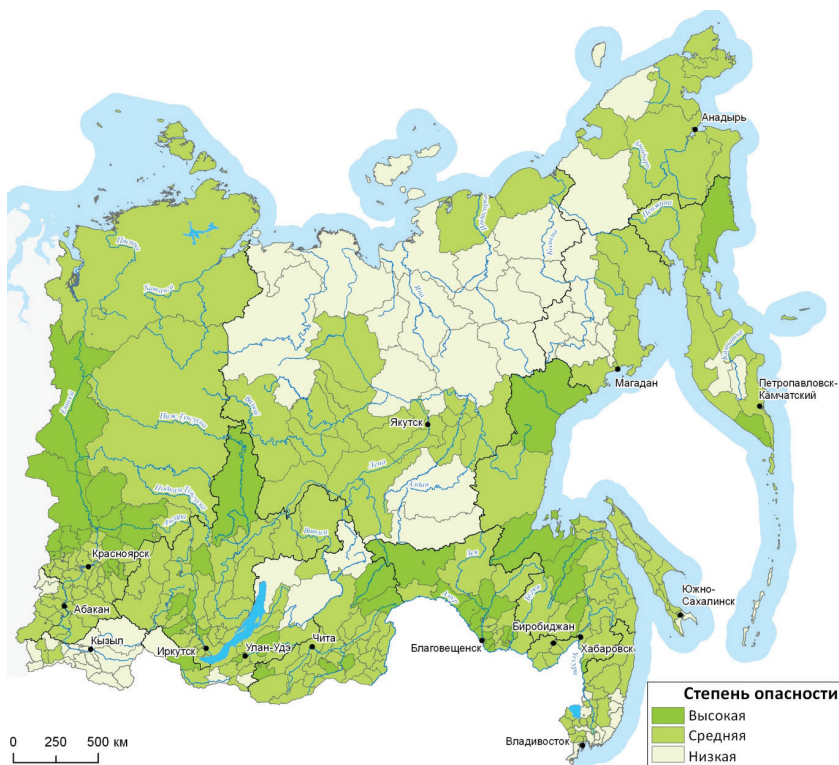
Рис. 2.2.2. Степень опасности морозного пучения для автомобильных и железных дорог в начале XXI века по муниципальным образованиям территории Восточной Сибири и Дальнего Востока
