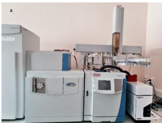
Рис.2. Системы ГХ/МСВР Orbitrap ExactiveGC с термодесорбером UnityXR (а) и ГХ-ГХ/МСВР Pegasus GC-HRT+ 4D (б) в лабораториях ЦКП НО "Арктика"
