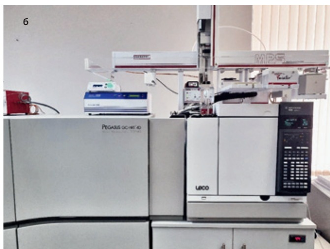
Рис.2. Системы ГХ/МСВР Orbitrap ExactiveGC с термодесорбером UnityXR (а) и ГХ-ГХ/МСВР Pegasus GC-HRT+ 4D (б) в лабораториях ЦКП НО "Арктика"
