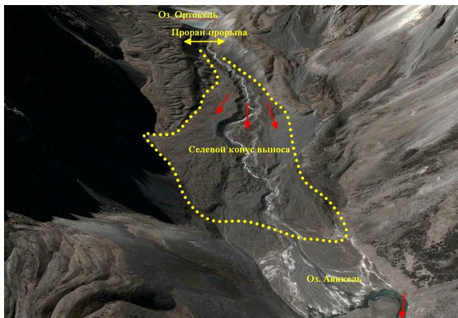
Рис. 10. В устье длинного и глубокого, с V-образным поперечным профилем, прорана после прорыва озера Ортокель образовался обширный селевой конус выноса. Источник: GoogleEarth
