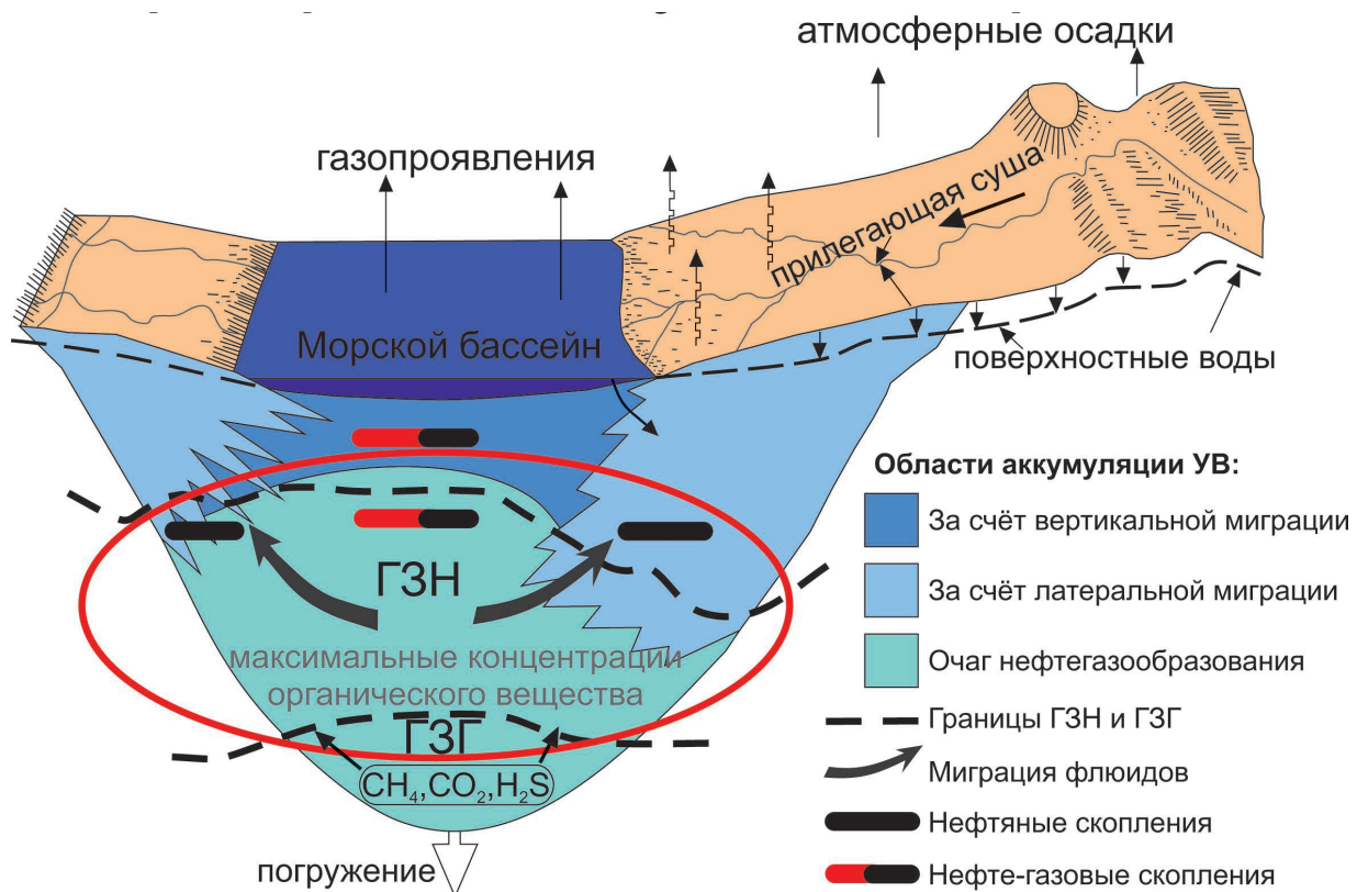
Рисунок 9. Зоны максимальной концентрации углеводородов в сланцевых породах расположены в наиболее прогнутой части бассейна [36, 41]
