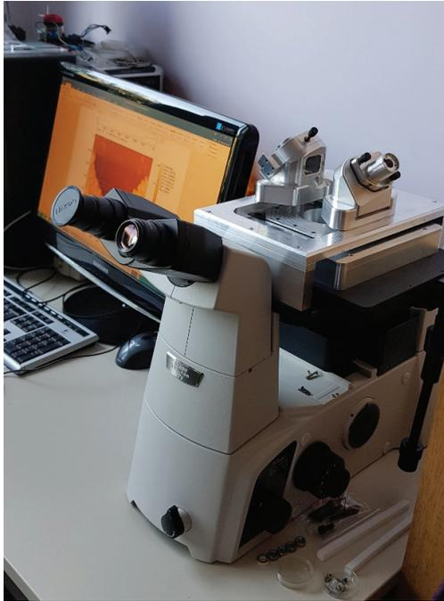
Рис.2. Разработанная установка для совмещенной зондовой и капиллярной микроскопии ФемтоСкан Xi, установленная на инвертированный оптический микроскоп Nikon Ti-U
