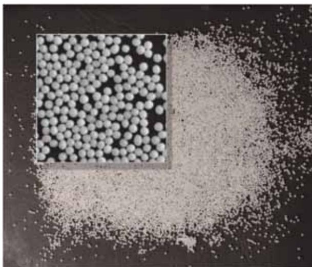
Рисунок 5-22. Пример изображения пеллет для определения толщины покрытия [208].
