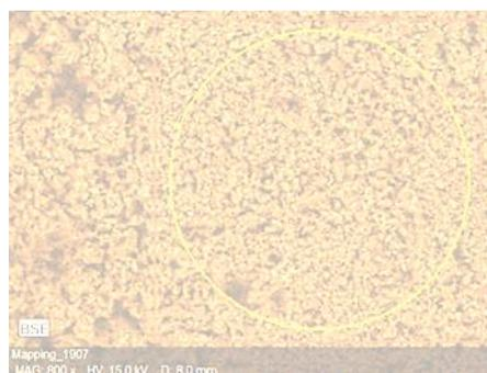
Рис.2 Морфология поверхности нанокompозита ZnO-АГ.
