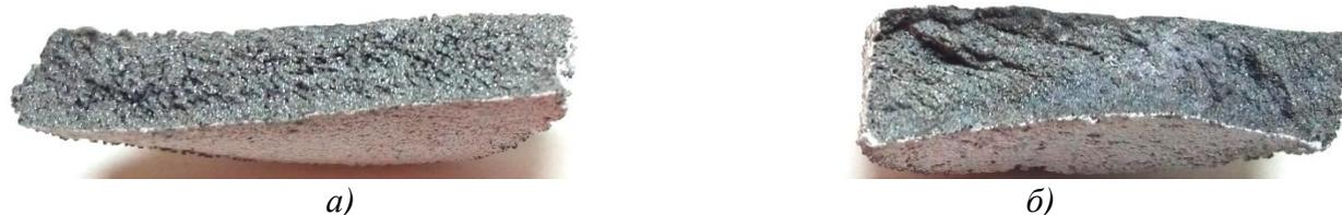
Рис. 4 Фотографии поверхности излома образцов без замены (а) и с заменой 20 % углерода на порошок  $(AlN+5\%Na_3AlF_6)$  (б)
