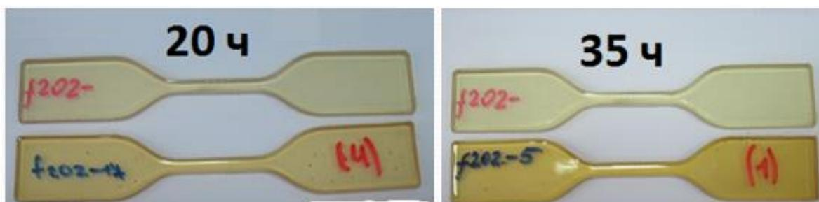
Рис.1 Изменение цвета полиуретановых образцов по времени воздействия температуры (сверху контрольный образец-сравнения).
