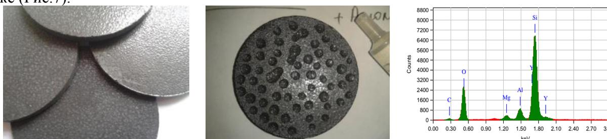
Рис.7 Высокотплотные керамические образцы смешанного карбидно-оксидного состава:  $SiC+MgO+Y_2O_3+Al_2O_3$  на основе органомагнийоксаниитрийоксаналюмоксана.
