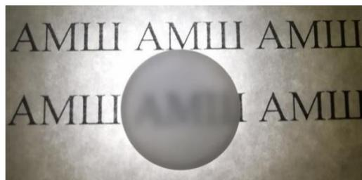
Рис.8 Фотография образца керамики на основе алюмомагнезиальной шпинели, легированной оксидом галлия
