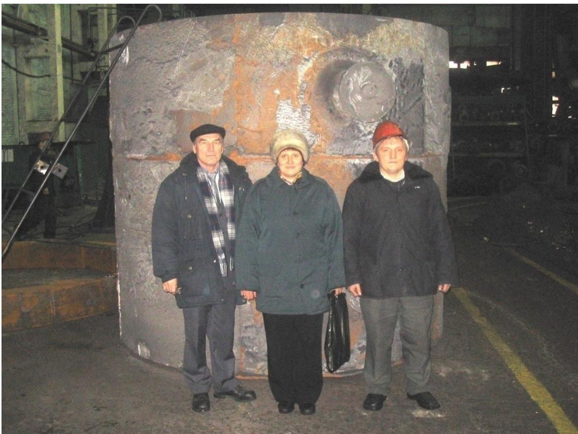
*Рис.2 Крупная изложница для кузнечных слитков энергетического машиностроения из доменного передельного чугуна массой 42 т.*
