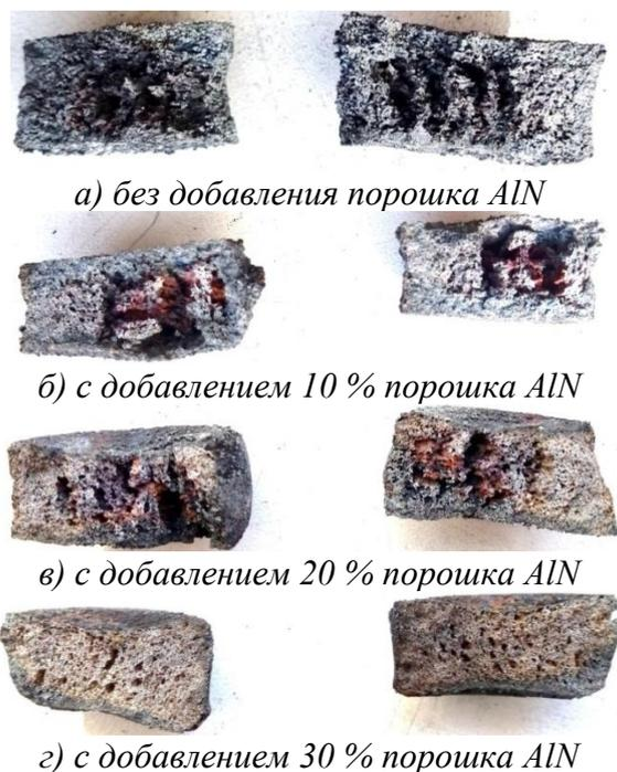
Рис. 2 Фотографии поверхности излома образцов с добавлением различного количества порошка  $AlN+5\%Na_3AlF_6$
