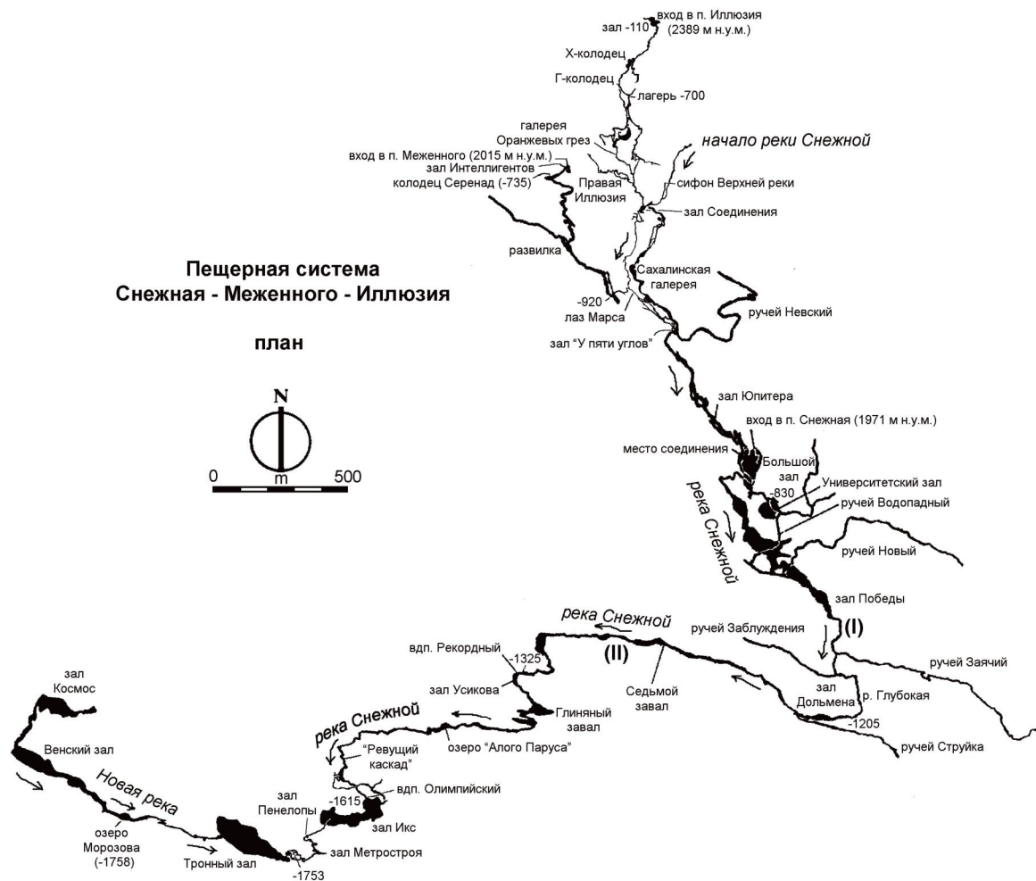
Рис. 3. Топографический план системы Снежная. Показаны направления течения двух основных рек системы и места выпуска красителя (I, II). Отметки глубин указаны от верхнего входа в систему.
