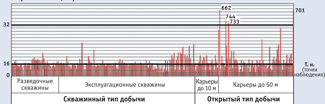
Рис. 2. Состояние почв на горнодобывающей территории по суммарному показателю загрязнения (Zc). Обозначения: чёрными горизонтальными линиями отмечены уровни загрязнения почв по Zc (СанПиН 2.1.7.1287–03): меньше 16 – допустимый; 16–32 – умеренно опасный; больше 32 – опасный. Числа на графике соответствуют номерам точек опробования с максимальными значениями Zc.
