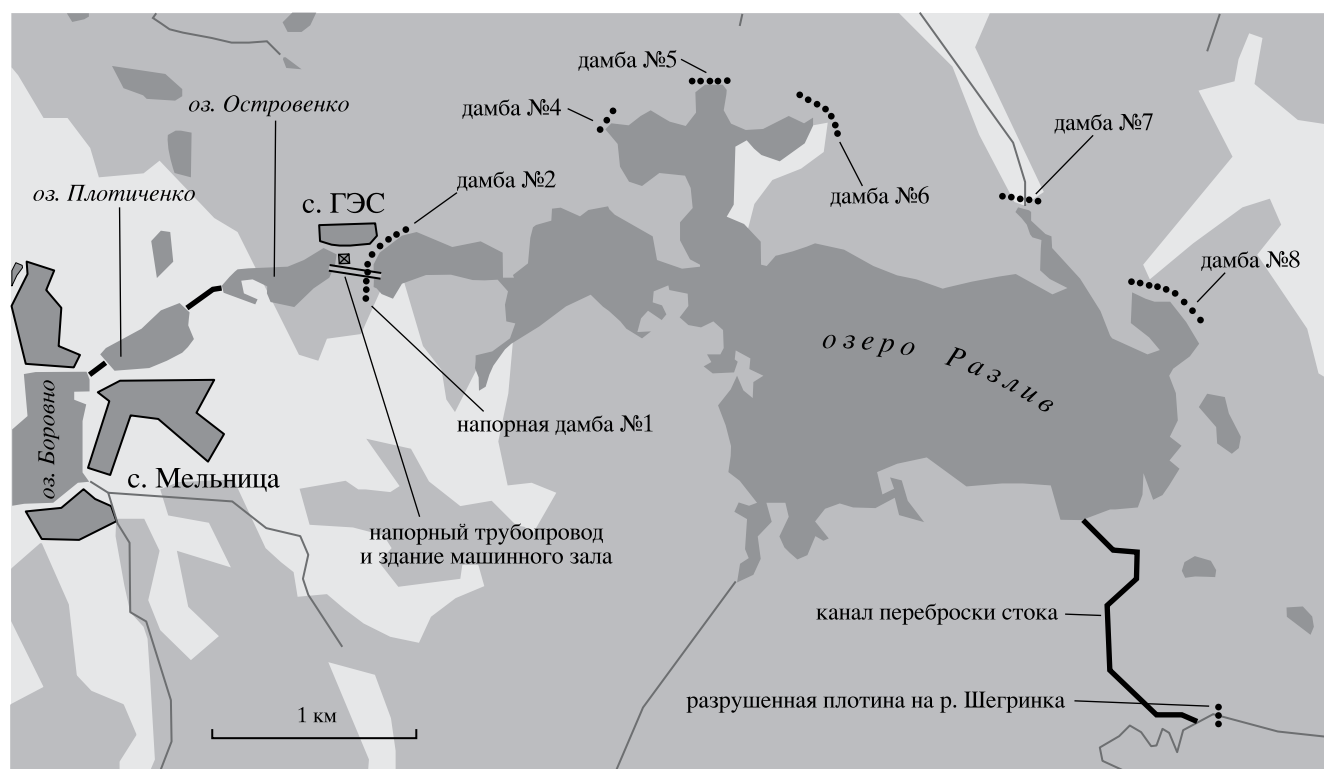
Рис. 1. Схема гидротехнических сооружений оз. Разлив и Боровно.
