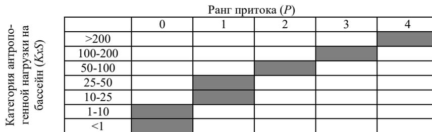
**Рис. 4.1.** Номограмма для определения условий выделения бассейнов (ЭРС) – притоков главной реки.
