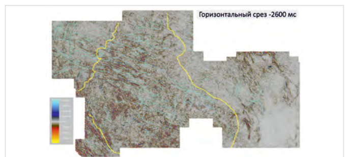
Рис. 7 — Горизонтальный срез куба дифрагированных волн на времени -2600 мс с нанесенными полигонами тектонических нарушений (голубой цвет) и границами сейсмофациальных зон (желтый цвет). Fig. 7. — A horizontal section of the cube of diffracted waves at a time of -2600 ms with plotted tectonic fault polygons (blue color) and the boundaries of seismic facies zones (yellow color).
