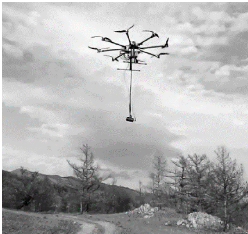
Рисунок 1. Октокоптер с одним из первых прототипов магнитометра и гексакоптер, использующийся для предварительных полетов.
