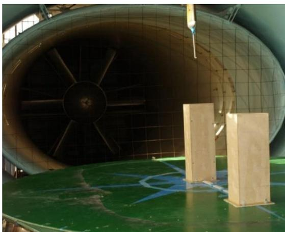
Рис. 3.4. Общий вид модели сооружения в аэродинамической трубе.
