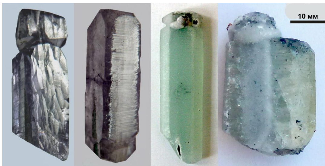
Рис. 1. Внешняя морфология монокристаллов Cr-содержащего топаза, выращенного в сверхкритических водно-фторидных растворах.
