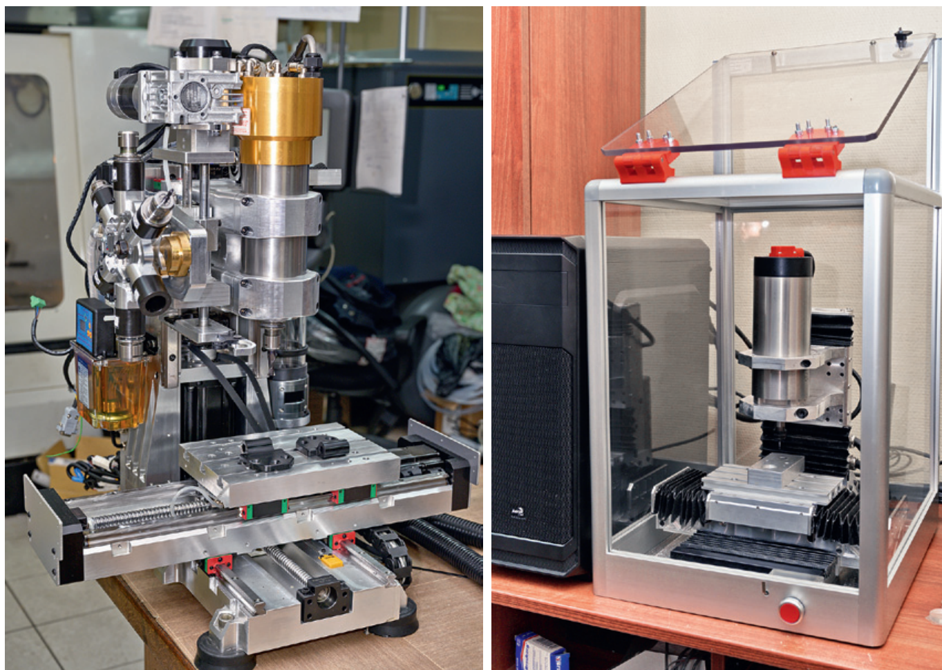
Рис.3. 2019 год. Созданные нами конструкции: обрабатывающий центр с числовым программным управлением и автоматической инструмента АТС "Индустрия 4.0" (слева) и фрезерный станок АТС "Нано" (справа)
