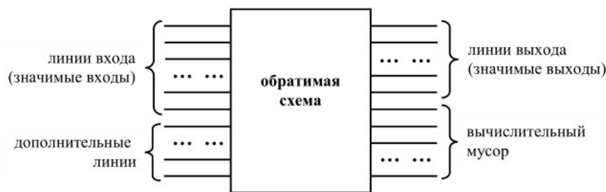
Рис. 10. Входы и выходы обратимой схемы
