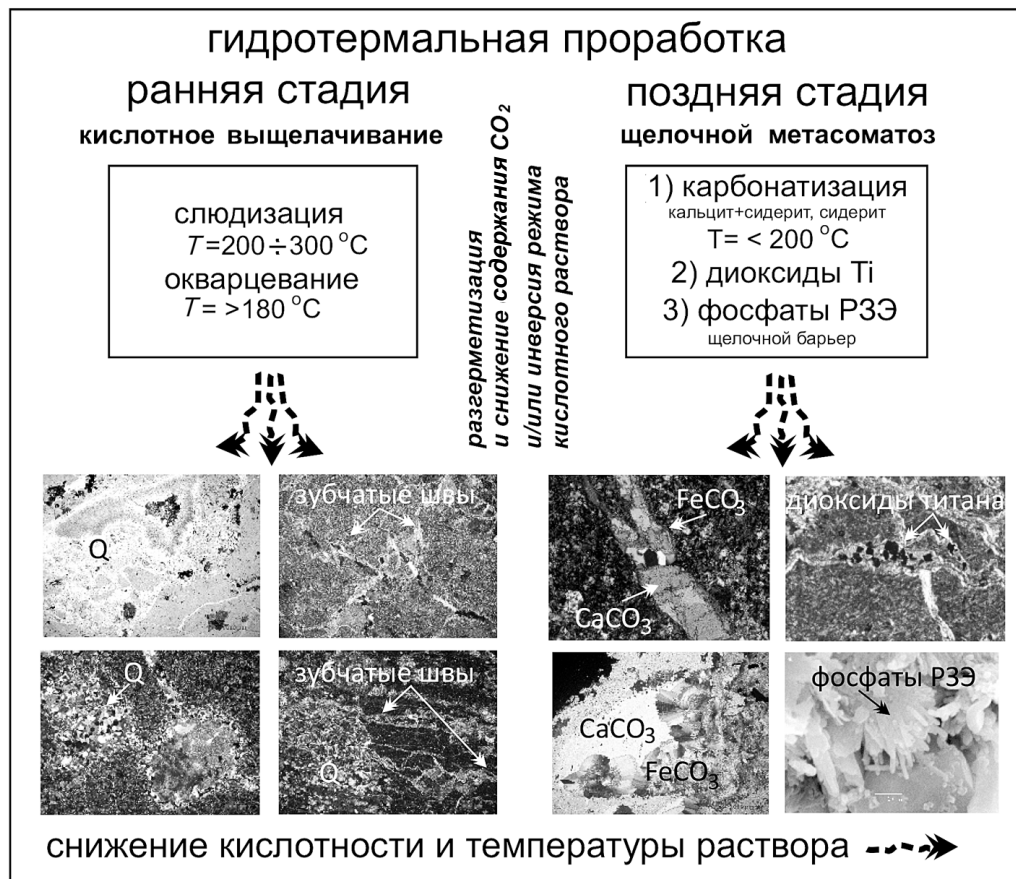
Рис. 3. Последовательность гидротермальной переработки изучаемых вулканитов. Q — кварц, \text{CaCO}_3 — кальцит, \text{FeCO}_3 — сидерит
