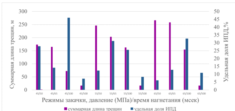
Рисунок 6. Суммарная длина трещин и доля интенсивности пластической деформации в зависимости от режима нагнетания флюида в трещину пятой пачке, чем псевдостационарное решение варианта 65/100 (Рисунок 7), предпочтение отдается последнему. Этот вариант и считается реализующим оптимальную закачку (Бек Д.Д. и др., 2017).
