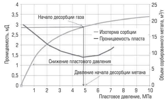
Рис. 1. График изменения проницаемости, связанный с раскрытием системы трещин и усадкой матрицы вещества угля
