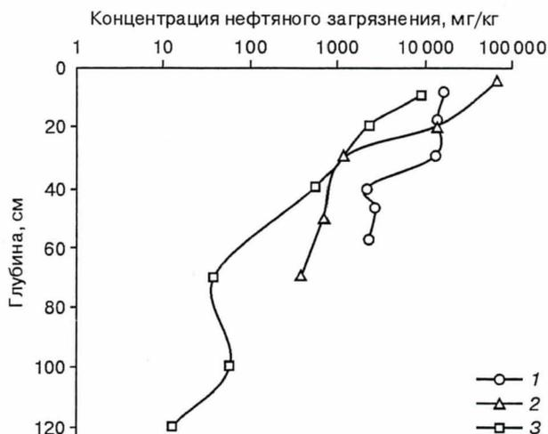
Рис. 12. Характер распределения содержания нефтяного загрязнения в грунтах по глубине на различные моменты времени на экспериментальных участках № 3, 6 и 9.
