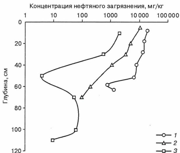
Рис. 13. Характер распределения содержания нефтяного загрязнения в грунтах по глубине на различные моменты времени на экспериментальных участках № 1, 4 и 7.
