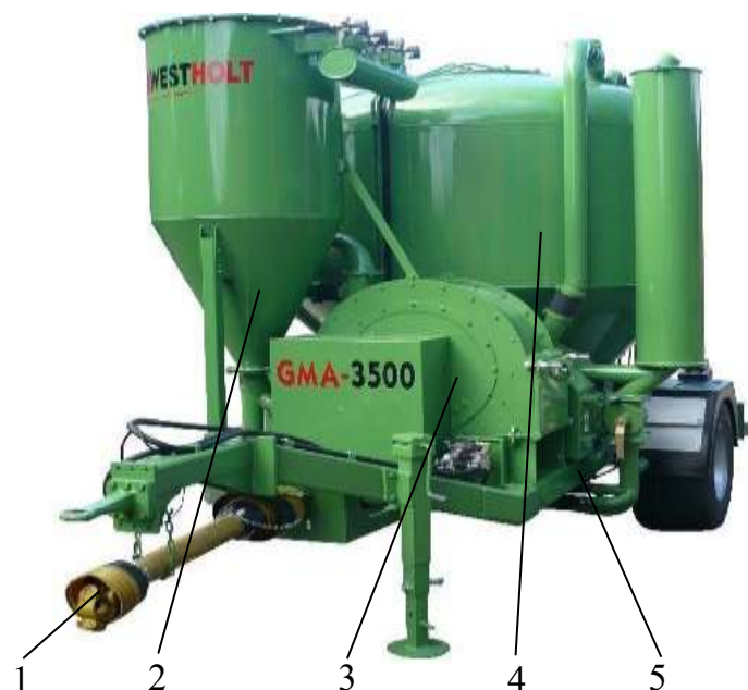
Рис. 4.9. Мобильный прицепной комбикормовый агрегат Riela GMA-3500: 1 – карданный вал; 2 – емкость для жидкого сырья; 3 – молотковая дробилка; 4 – вертикальный смеситель; 5 – шасси
