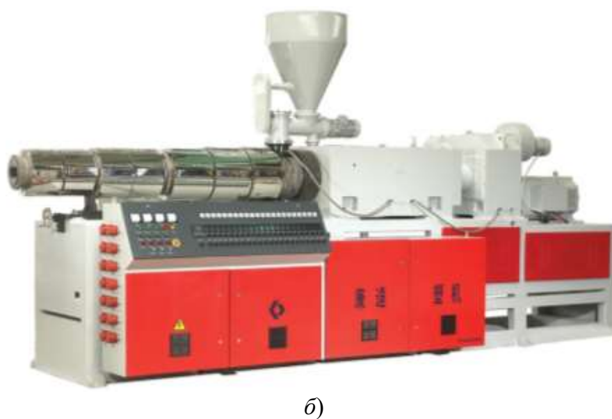
Рис. 3.70. Двухшнековый экструдер: а – схема: 1 – корпус; 2 – шнек; 3 – привод; б – общий вид
