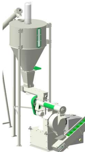
Рис. 3.124. Бункер-питатель (оперативный бункер): а – общий вид; б – размещение бункера-питателя над пресс-гранулятором
