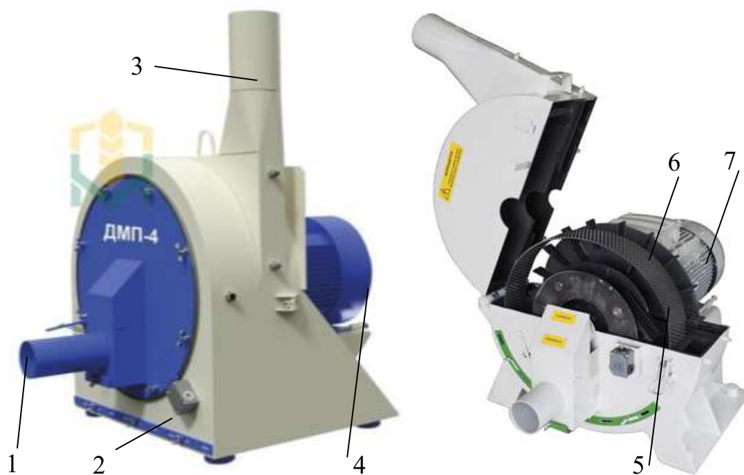
Рис. 3.20. Дробилка молотковая ДМП-4 «Агрогрант»: 1 – загрузочная горловина; 2 – корпус; 3 – выгрузная горловина; 4 – электродвигатель; 5 – ротор; 6 – сито; 7 – вентилятор
