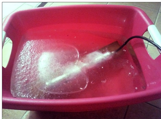
Рис. 1. Общий вид промораживаемой пластиковой емкости с датчиком порового давления, укрепленным на деревянной доске; над датчиком виден воздушный пузырь в промерзающей закрытой системе (опыт проведен в Москве 29.01.2018 г.).
