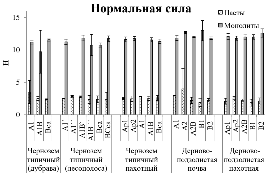
Рисунок 14. Величина нормальной силы в начале осцилляционного амплитудного теста.
