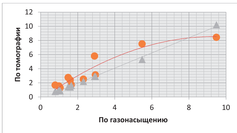
Рис. 5. График сопоставления результатов рассчитанной и измеренной пористости по образцам углей из керна нерабочих пластов Воркутской мульды (оранжевый – рассчитано по томографии, серый – измерено методом газонасыщения)
