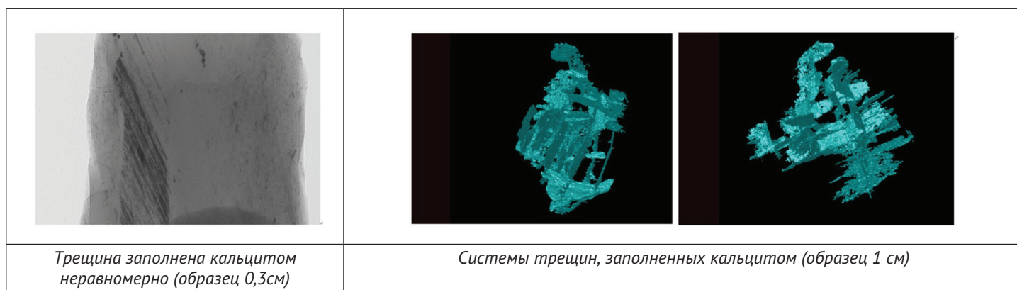
Рис. 6. Примеры микрофотографических исследований. Микротрещины заполнены кальцитом (антрацит, бассейн Циньшуй (КНР))
