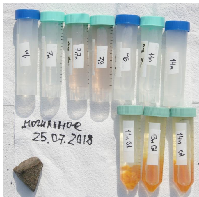
Пробы для определения концентрации сероводорода, зафиксированные ацетатом цинка и ацетатом кадмия
