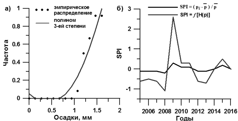
Рис. 2. Частота распределения осадков (а) и динамика годового индекса SPI (б) в Ташкенте за период 2005-2016 годы.
