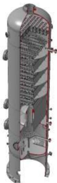
**Рис.1. Абсорбционная колонна в разрезе**
